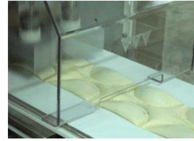
**Dispositivo Cortador Longitudinal de Masa** con tres ruedas de corte de acero inoxidable, independientes y regulables para el corte longitudinal.
